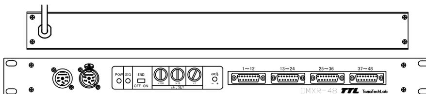
**タイプB** (フロント :DMX入力、THRU 出力、スイッチ、表示灯／リア : アナログ出力 [MS小マルチ ×8])
