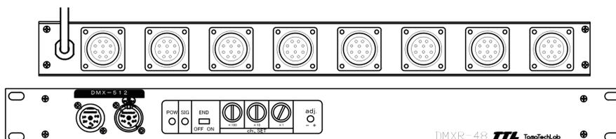
**タイプC** (フロント :DMX入力、THRU 出力、スイッチ、表示灯／リア : アナログ出力 [D-subオス15P×4])
