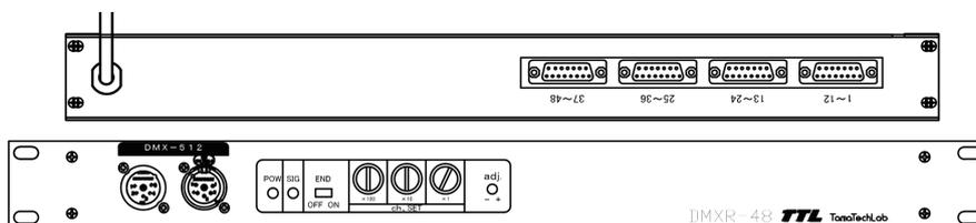
**タイプD** (フロント : 表示灯のみ／リア : DMX入力、THRU 出力、アナログ出力 [D-subオス15P×4]、スイッチ、表示灯)
