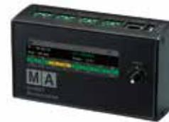
grandMA3 8Port Node DIN-Railは、大量のデータをイーサネットからDMXに変換するための最もコンパクトで費用対効果の高いソリューションです。ノードは、grandMA3セッション内で8個のDMXユニバースを同期して出力します。最適化されたDINレールハウジングは、あらゆる種類の固定設置での簡単で時間を節約した取り付けを可能にし、PoE (Power over Ethernet) からの給電も可能です。
